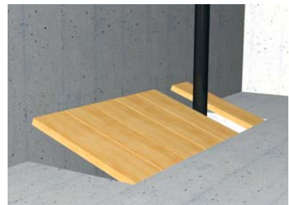
Kleine Bodenöffnung im Wandbereich mit verkeilten Brettern
